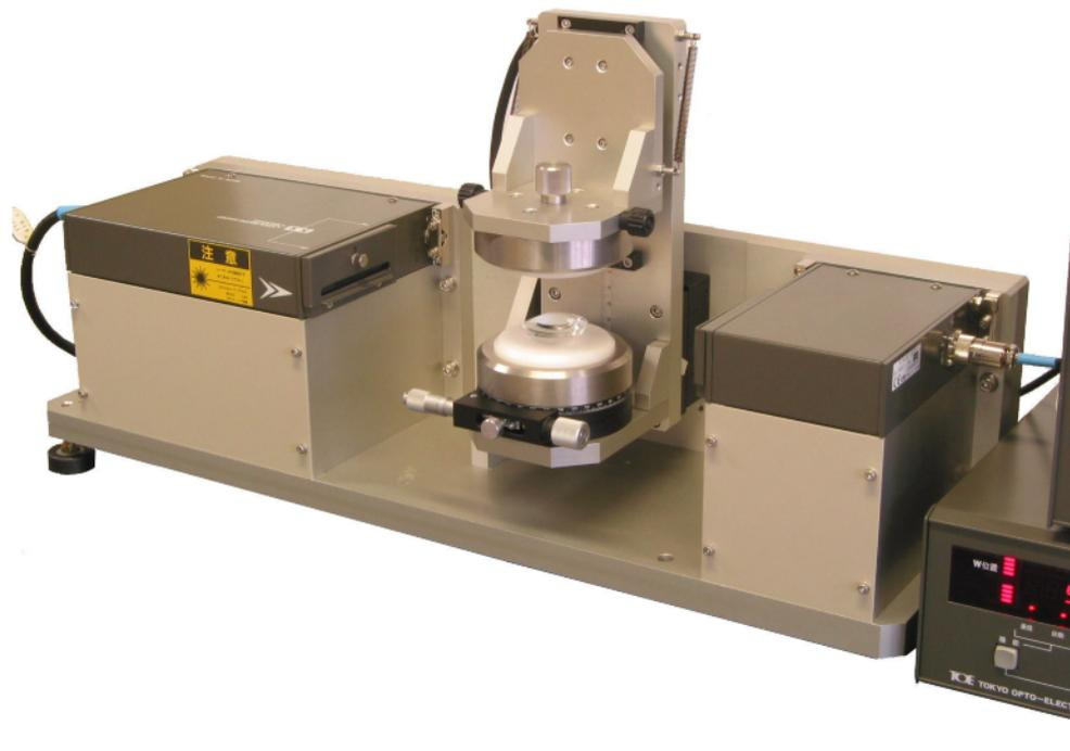
レーザマイクロゲージとレンズ移動用ステージが一体となって、パソコンで制御しながら自動的にレンズ曲面を測定する装置です。
